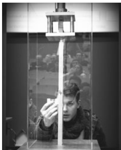
Abb. 3: Ausrichten des Tischbeins in der Prüfvorrichtung (Foto: ProStep)
