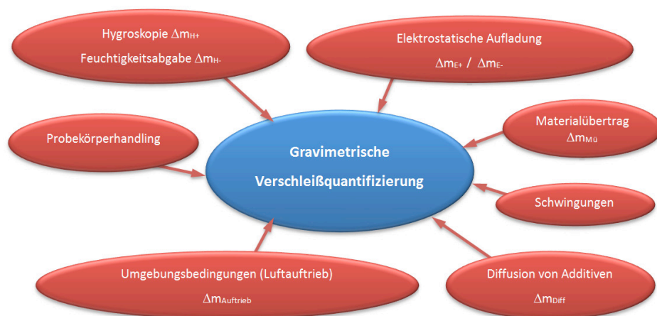
Abbildung 3: Einflussfaktoren/Störgrößen bei der gravimetrischen Verschleißquantifizierung
