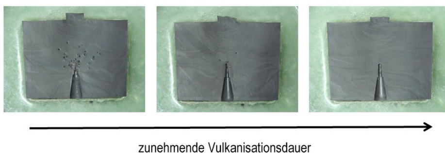
Abbildung 5: In der Mitte aufgeschnittene Zylinder mit unterschiedlichen Heizzeiten. Von links nach rechts nimmt die Heizzeit zu. Deutlich sind in den untervulkanisierten Bereichen Blasen zu erkennen. In der Mitte des Zylinders entsteht eine Aussparung durch das Thermoelement, in welcher sich bei der Dichtemessung Luftblasen der gleichen Größenordnung der Blasen im Bauteil ansammeln.
