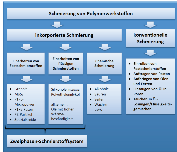
Abbildung 1: Schmierungsvarianten von Polymerwerkstoffen
