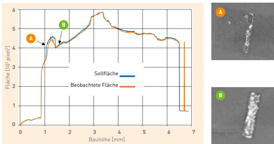
Abbildung 4: (links) Verlauf der berechneten Fläche des aufgeschmolzenen Metalls im Pulverbett und gewünschte Fläche, (rechts) beispielhafte Relation zu Kamerabildern im Fall A für eine signifikante Abweichung Soll zu beobachtet und Fall B fehlerfreier im gleichen Bauteilbereich
