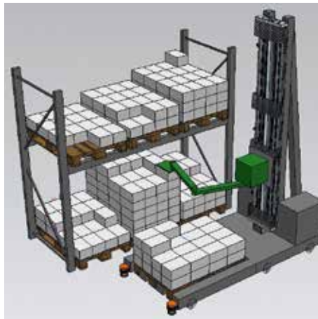
Abbildung 4: Konzept eines mobilen Kommissionierroboters für den »Griff ins Regal«
